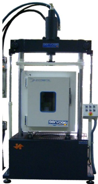
Cámara climática frío/calor instalada en máquina universal de ensayos MUF 401
