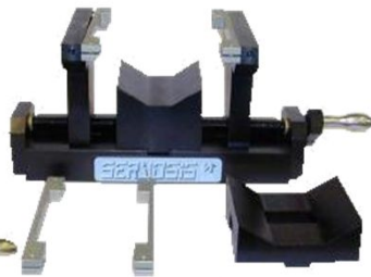
UNE-EN-12697-24: 2006. ANEXO E RESISTENCIA A LA FATIGA ENSAYO DE TRACCION INDIRECTA SOBRE PROBETAS CILINDRICAS. Fig. E.1
