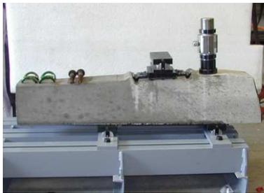
**MODELO:** Este tipo de ensayos se realizan empleando actuadores dinámicos, capaces de trabajar en frecuencias hasta 100 Hz.
