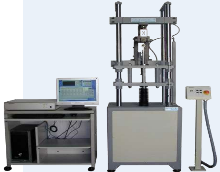
ME 402 0,5T con utillaje específico para ensayos de tubos de amortiguadores
