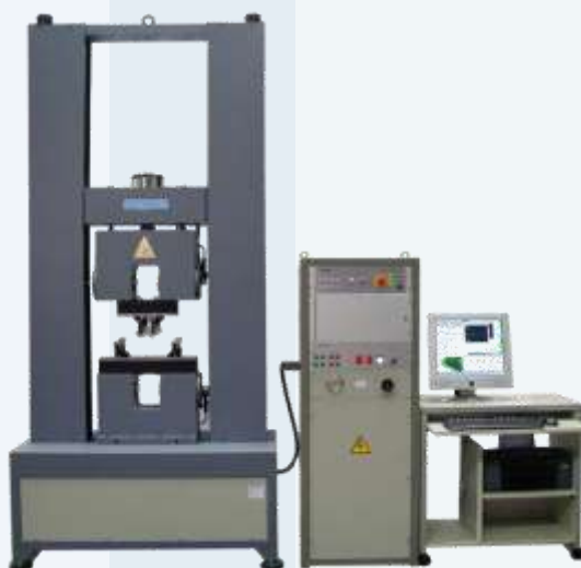
ME 405 + MORDAZAS DE ACCIONAMIENTO LATERAL SERIE 4013 + UTIL FLEXION 4 PUNTOS
