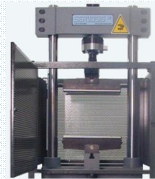
Marco de ensayos a flexión con rodillos basculantes
