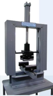
Pórtico de flexión a 3 puntos con rodillos desplazables .
