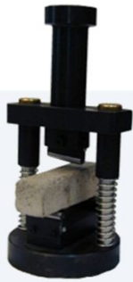
Dispositivo para ensayos de flexión sobre probetas de cemento prismáticas.
