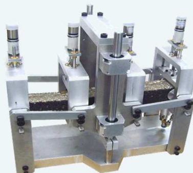
UNE-EN-12697-24:2006. ANEXO D ENSAYO DE FLEXIÓN EN 4 PUNTOS SOBRE PROBETAS PRISMATICAS. Fig. D.1
