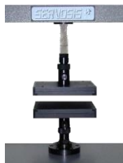
UNE 1607 Tensile strength perpendicular to faces.
