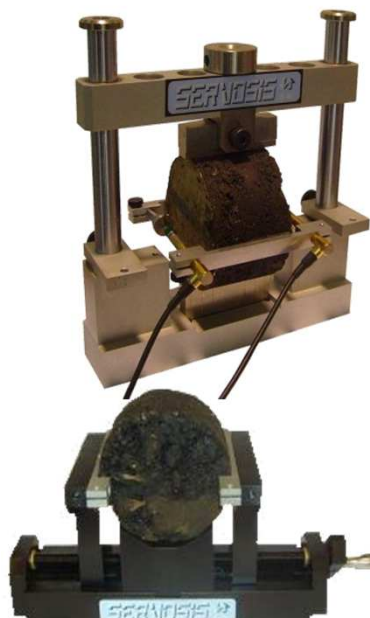
ISO-EN-12697-24: 2006. ZAŁĄCZNIK E ODPORNOŚĆ NA ZMĘCZENIE
