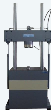
MUF 401 – C.I– B.A /10t Maks.siła: 100 kN Łoże maszyny na ramie, siłownik w dolnej części.
