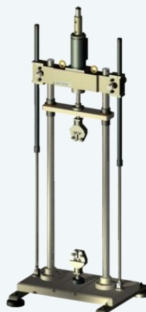
MUF 401 - C.S – B.B /2,5 t Maks. siła 25 kN Rowkowane dolne łożo. Cylinder w górnej części. Stożkowe zamknięcie, seria 4011
