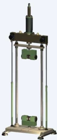
MUF 401 –C.S – B.B/ 10t. Maks.. siła: 100 kN. Rowkowane dolne łożo . Cylinder w górnej części. Boczenie sterowane zaciski, seria 4013
