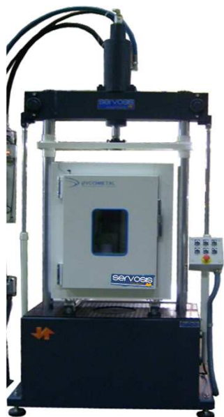
Komora do badań klimatycznych ciepło- zimno zainstalowana w uniwersalnej maszynie do badań MUF 401.
