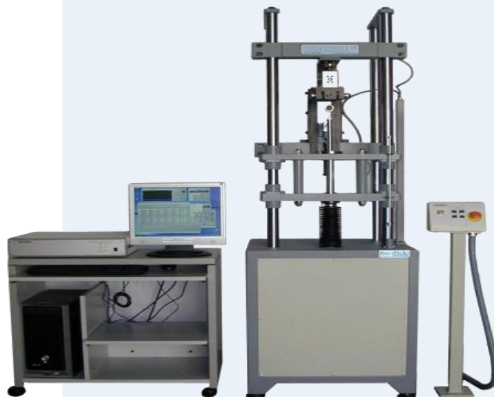
ME 402 0,5T ze specjalnym oprzyrządowaniem do badań rur amortyzatorów
