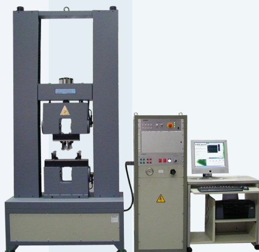
ME 405 + MORDAZAS DE ACCIONAMIENTO LATERAL SERIE 4013 + UTIL FLEXION 4 PUNTOS
