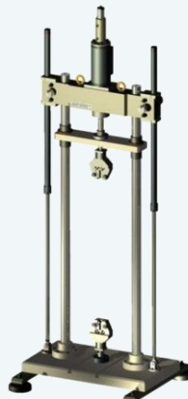
MUF 401 - C.S – B.B /2,5 t F.Max 2,5t Bancada ranurada inferior. Cilindro superior. Mordazas accionamiento cónico, serie 4011
